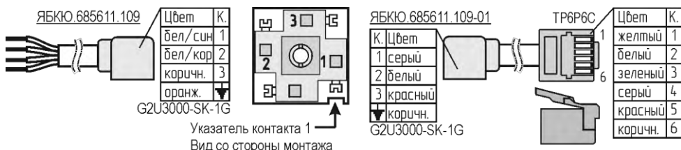
Рисунок 3 – Схема кабелей ЯБКЮ.685611.109 и ЯБКЮ.685611.109-01.
